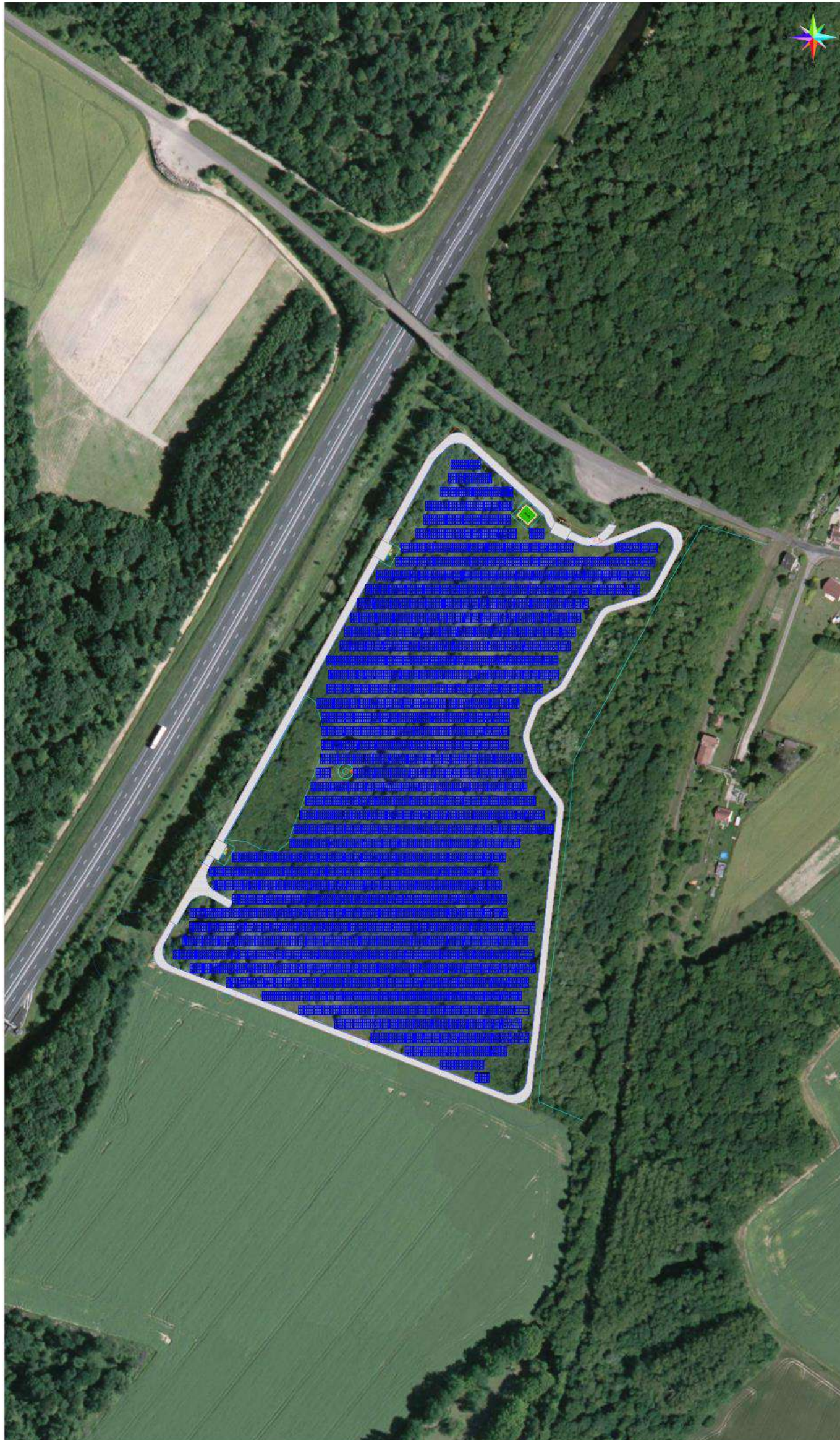
Figure 20 : Plan masse de la centrale photovoltaïque de Villeneuve-la-Dondagre
