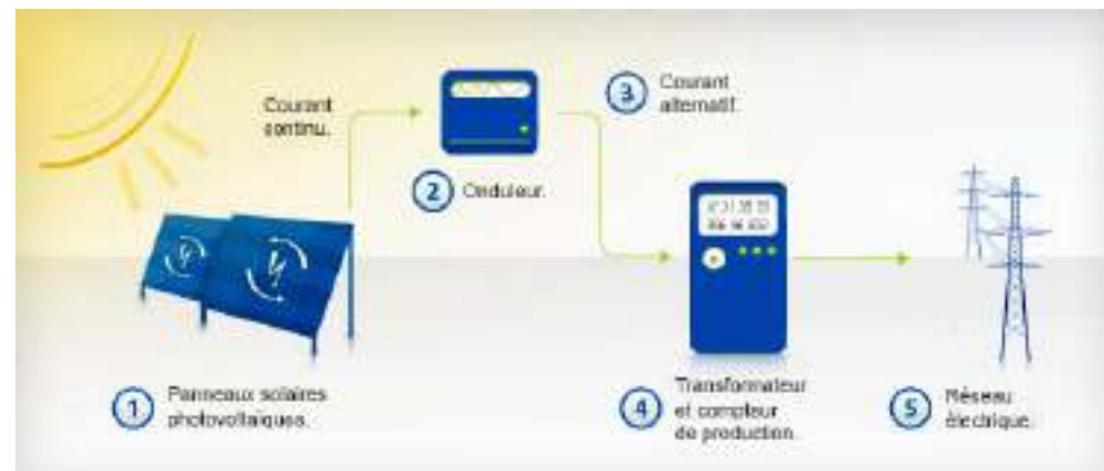
Figure 10 : Schéma descriptif du fonctionnement des modules solaires
