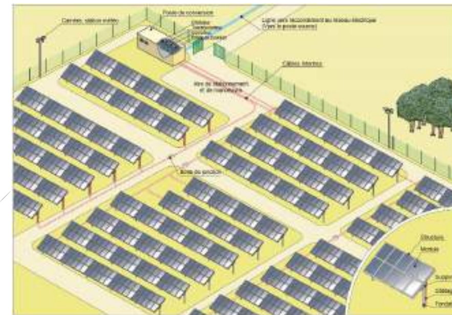
Figure 11 : Schéma de principe d'une centrale-type photovoltaïque
