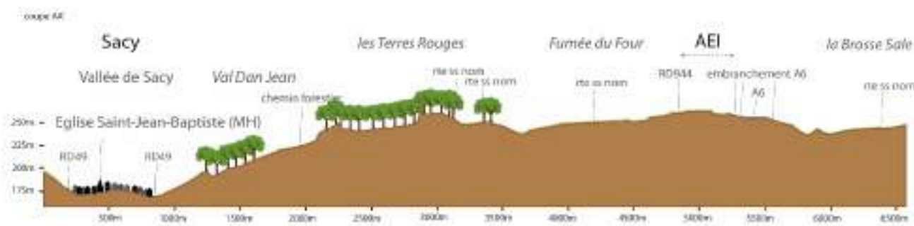
Figure 66 : Coupe AA' montrant l'absence de visibilité et de co-visibilité entre l'Eglise Saint-Jean-Baptiste (MH) et l'AEI. Echappées visuelles contraintes par la topographie.
