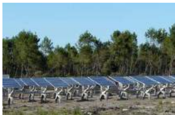
Photographie 1 : Structures solaires (à gauche : les trackers de la centrale de Gabardan (40) qui suivent le soleil ; à droite : structures fixes à Puylobier (13))
