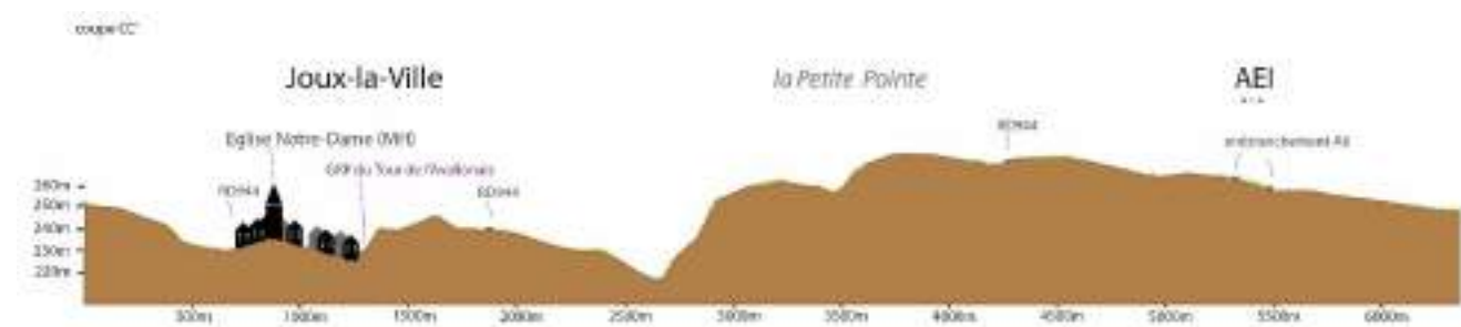
Figure 65 : Coupe CC' montrant l'absence de visibilité et de co-visibilité entre l'Eglise de Notre-Dame (MH) présente à Joux-la-Ville et l'AEI. Echappées visuelles contraintes par la topographie
